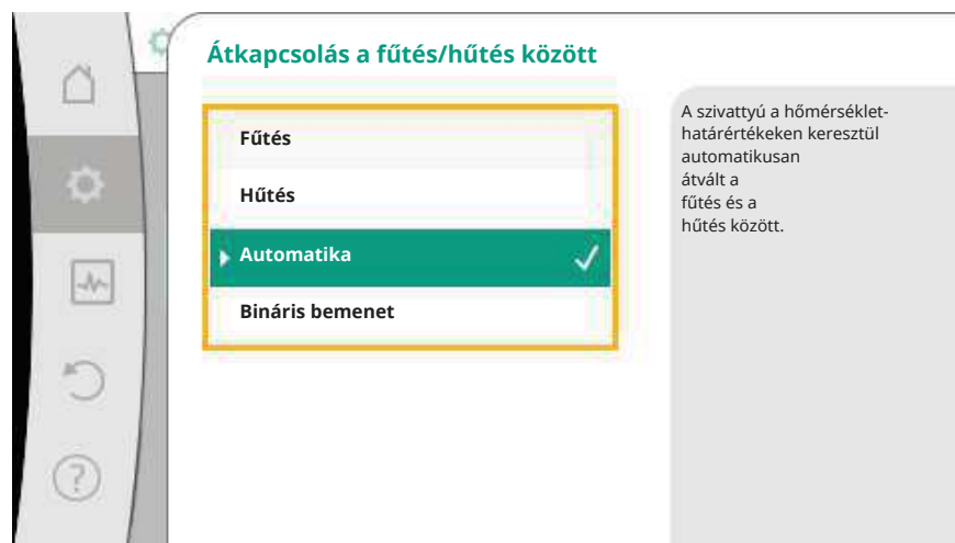
Fig. 56: Átkapcsolás a fűtés/hűtés között_Automatika
