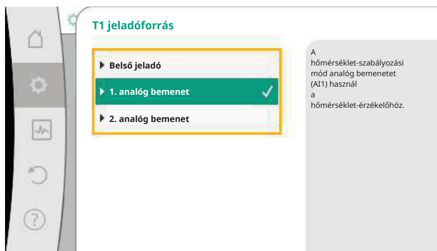
Fig. 52: A jeladó forrás hozzárendelése
