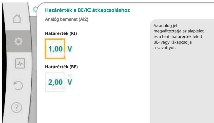
Fig. 74: Az analóg jelekkel végzett BE/KI vezérlés határértékei
