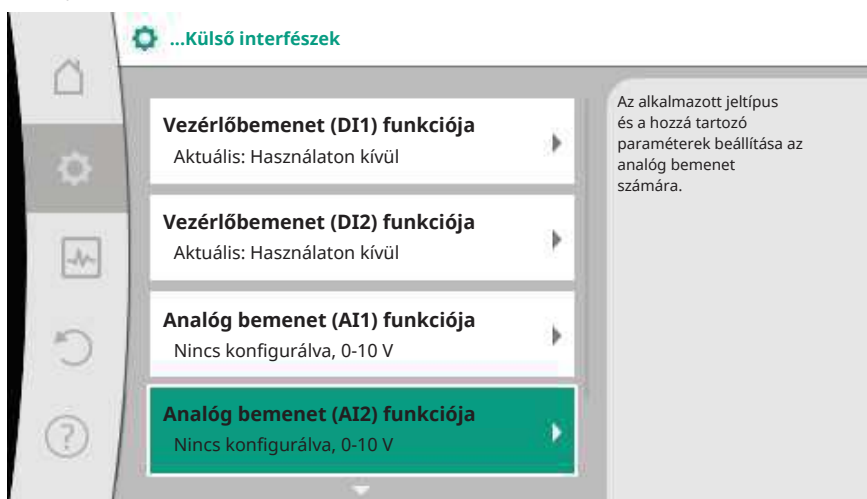
Fig. 62: Analóg bemenet funkciója
