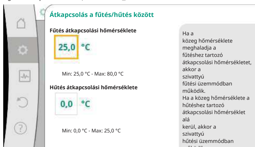
Fig. 57: Átkapcsolás a fűtés/hűtés között_Átkapcsolási hőmérsékletek
