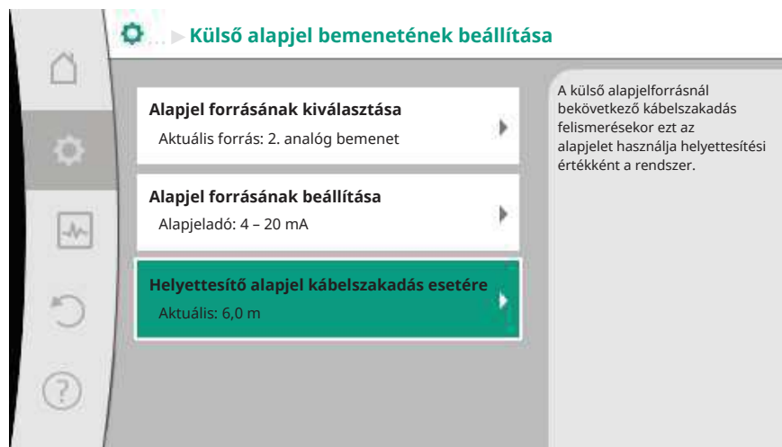
Fig. 77: Helyettesítő alapjel kábelszakadás esetére
